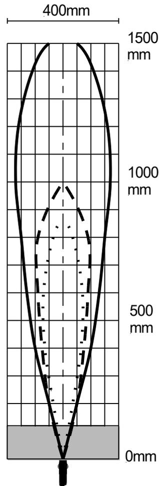
Nebenan sind die drei typischen Keulenformen für die DUPR-A Sensoren aufgezeichnet (kleine, mittlere und grosse Keule). Die Grösse der Schallkeule ist zudem von der Lufttemperatur und -feuchtigkeit abhängig. Je kälter und trockener, desto grösser ist die Keule.
